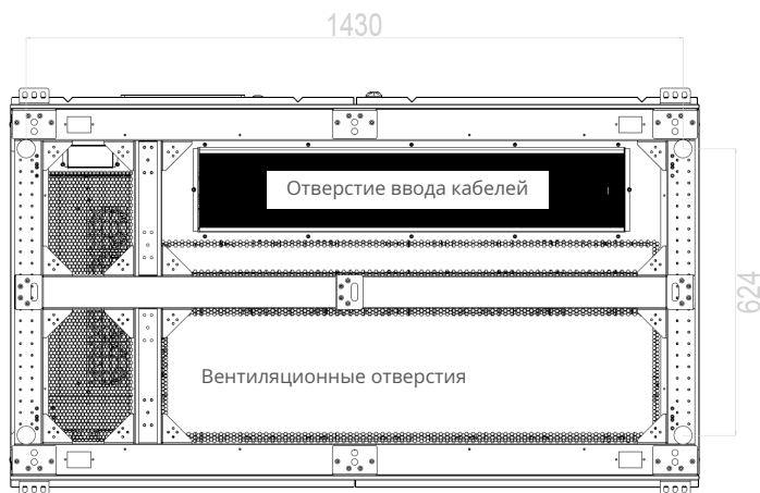
Рисунок 3.6. Опорная конструкция ИБП МОДУЛЬ ВТ300-7 (вид снизу)
